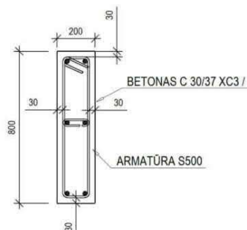
PRINCIPINIS COKLINĖS PLOKŠTĖS ARMAVIMAS
